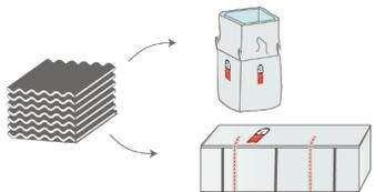
Les plaques de fibrociment, les ardoises ou encore les tuyaux amiantés doivent être conditionnés en sachet longue, en big-bag ou en body-benne spécifiques marqués du logo
